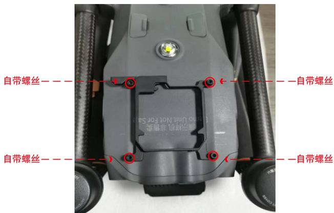
第二步：将探照警灯模块与快拆支架如图所示安装到位。
