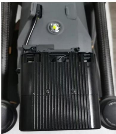
**第三步：**将探照警灯模块插头与无人机PSDK接口紧密相连。
